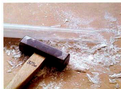
Leuchtstoffröhre ohne Splitterschutz
