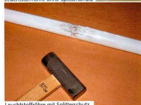
Leuchtstoffröhre mit Splitterschutz
