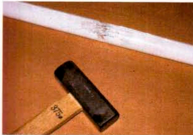
Splitterschutz Leuchtstoffröhren von American-Neons (Foto: ANS)
